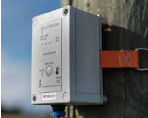
Schwingungssensor zur Aufnahme der Messdaten.
