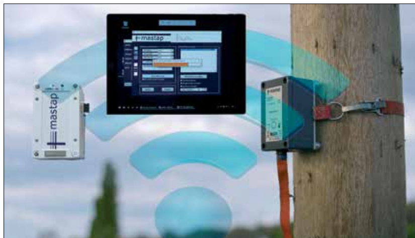
Bild 1: In netzpraxis 4/2017 angekündigte 3er-Lösung (Eingabegerät, Rechenbox und Messbox)
