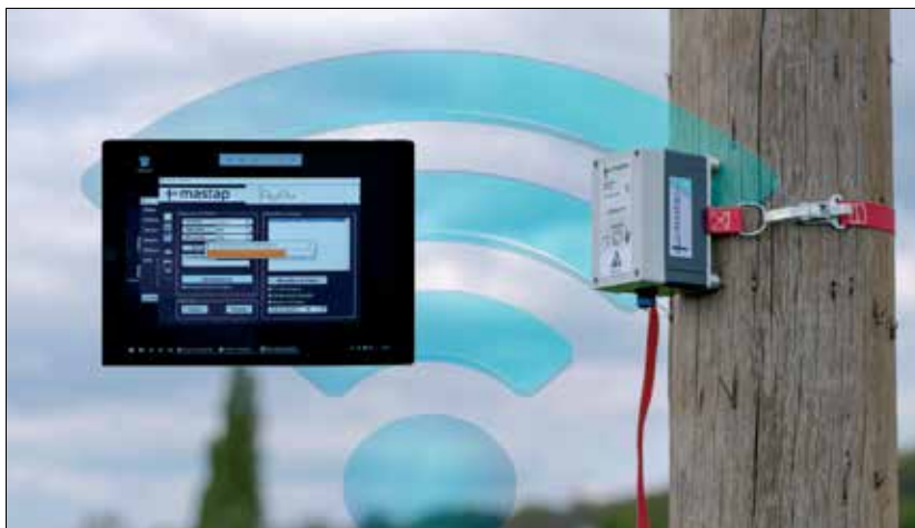
Bild 2: Aktuelle 2er-Lösung, bestehend aus Eingabegerät sowie kombinierter Mess- und Rechenbox
